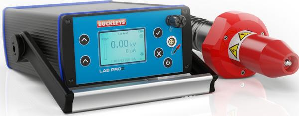
Das Lab Pro2 ist mit praktischem Klappständer / -griff erhältlich. Dank des breiten Spektrums an Zubehör und Elektroden kann der Benutzer das Lab Pro2 an eine Vielzahl von Testanforderungen anpassen.
